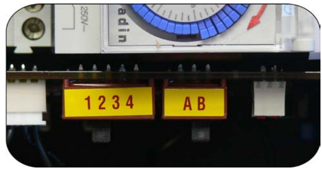
Figure 3. « 1 » = Fréquence 1 réglée toutes les 2 à 4 minutes; « 2 » = Fréquence 2 réglée toutes les 4 à 8 minutes; « 3 » = Fréquence 3 réglée toutes les 8 à 16 minutes; « 4 » = Fréquence 4 réglée toutes les 16 à 32 minutes; « A » = Volume faible; « B » = Volume élevé.
