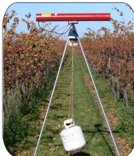
Figure 1. Vue latérale d'un canon effaroucheur. On voit, au sommet, le canon cylindrique et sa bouche (ici, du côté droit), le boîtier de commande (en haut, derrière), le trépied et le réservoir de propane.
